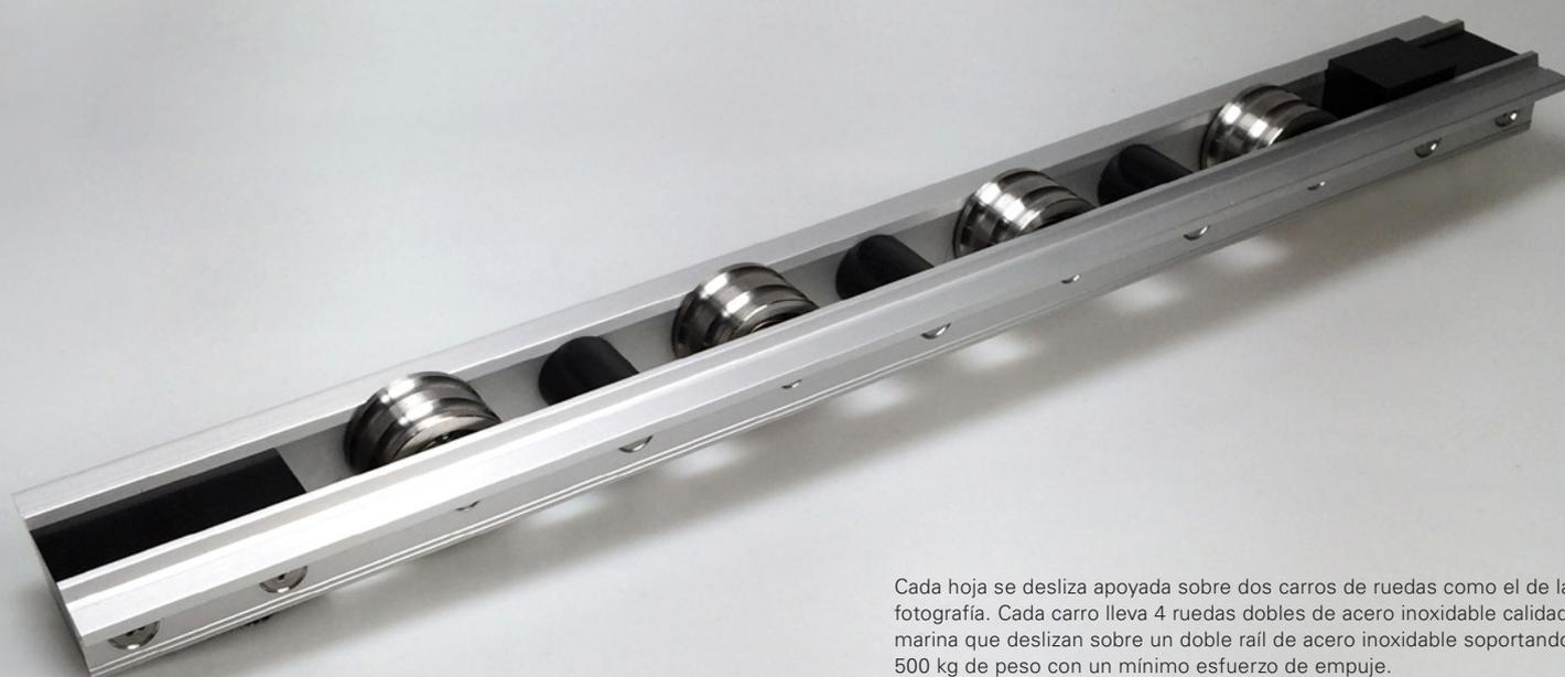
Cada hoja se desliza apoyada sobre dos carros de ruedas como el de la fotografía. Cada carro lleva 4 ruedas dobles de acero inoxidable calidad marina que deslizan sobre un doble raíl de acero inoxidable soportando 500 kg de peso con un mínimo esfuerzo de empuje.
